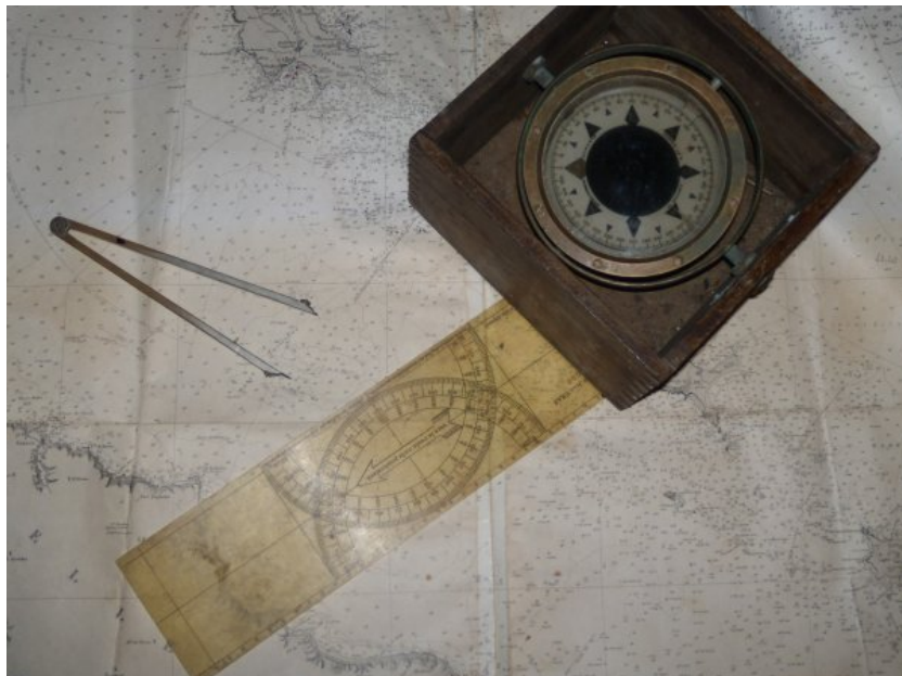
Outils de navigation : Pointes sèches, règle "Cras", compas (d'embarcation ici)
